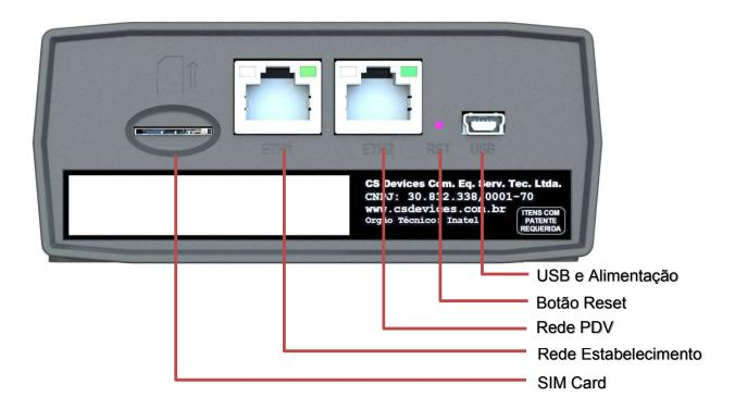
Figura 5 - Visão dos conectores na parte traseira do MFE
