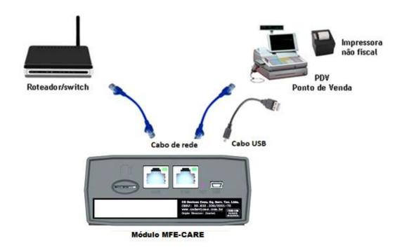
Figura 14 – MFE-CARE instalado fisicamente com todos os cabos
